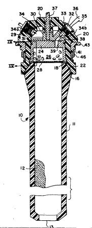
(NASA-Case-LAR-12018-1) MOLDED COMPOSITE PYROGEN IGNITER FOR ROCKET MOTORS Patent (NASA) 10 p CSCL 21H
