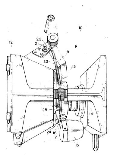
(NASA-Case-LAR-10319-1) EXPOSURE INTERLOCK FOR OSCILLOSCOPE CAMERAS Patent (NASA) 5 p CSC
