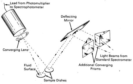
**Dual Beam Reflectance Apparatus**
