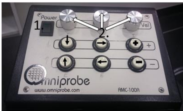
Joonis 17. Pult nanomanipulaatori nõela liigutamiseks; 1. – toitelüliti; 2. – nupud allolevate nuppude tundlikkuse reguleerimiseks, tundlikkus kasvab päripäeva suunas; „+“ liigutab nõela objektist kaugemale ja „-“ liigutab objekti suunas.
