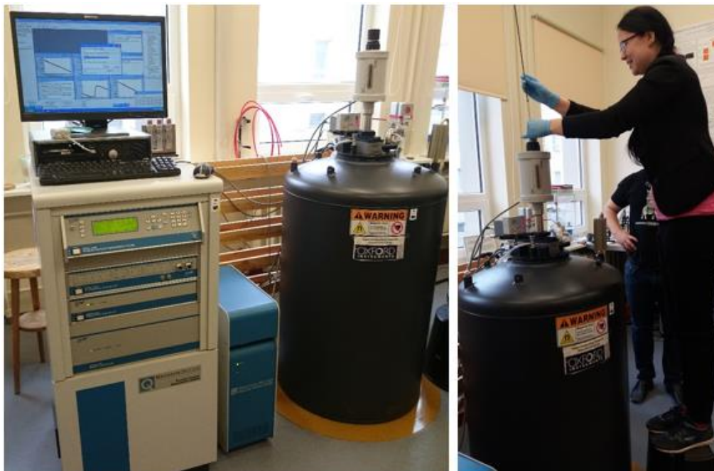
Joonis 9. P525 VSM-ga Quantum Design PPMS seade koos arvuti ja kontrollsüsteemiga (vasakul); proovi mõõtesüsteemi sisestamine (paremal), prooviga hoidja on keeratud pika varda alumisse otsa, pildil sisestab proovi töö autor.
