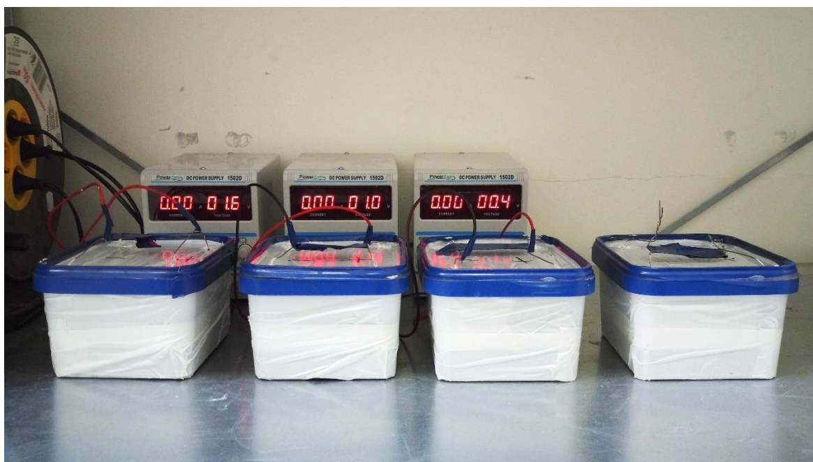
Joonis 7. Teise katse konfiguratsioon, ees on näha nelja MES-reaktorit ning kolme elektripingega manipuleerimiseks kasutatud toiteplokki.
