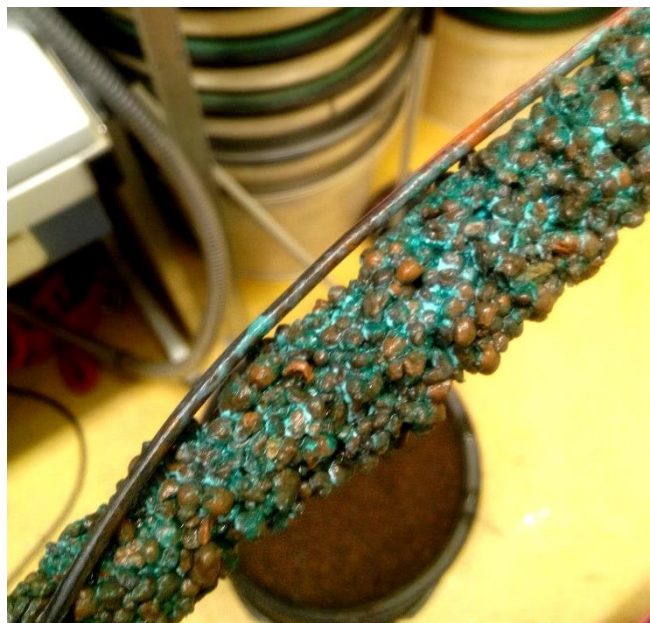
Joonis 25. Esimese katse käigus anoodile tekkinud vaskoksiidi kiht.
