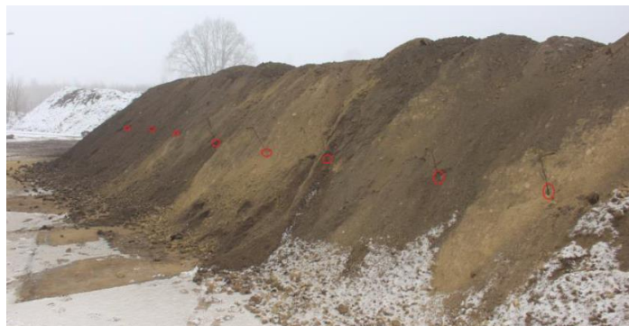
Joonis 8. Proovi võtmine samalt kõrguselt kindla horisontaalse intervalliga
