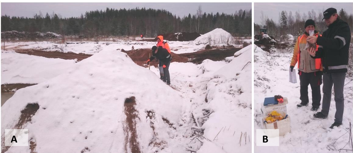
Joonis 9. Proovivõtt kuhjast nr 4: A – osaproovid võtmine; B – koondproovi segamine
