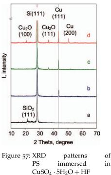
CuSO<sub>4</sub>  $\cdot$  5H<sub>2</sub>O + HF aqueous solution for: (a) o s, (b) 4 s, (c) 60 s, and (d) 180 s at 25 °C.
