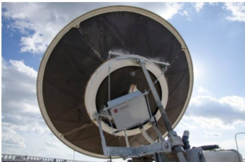
Le unità AC/DC e gli alimentatori a tensione d'uscita stabilizzata sono montati in un separato contenitore, anch'esso a tenuta stagna, dotato di connettori e cavi idonei all'uso in esterno.
