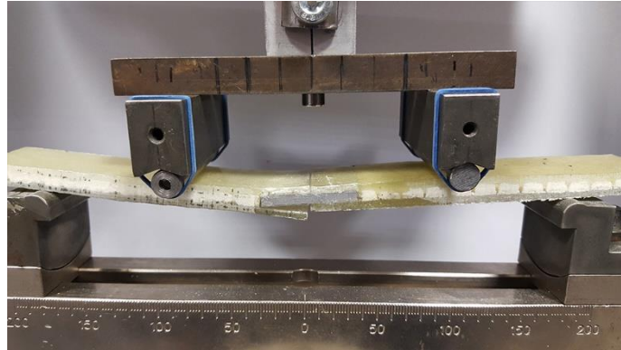
Figura 8. Prova di flessione a 4 punti: modalità di danneggiamento tipica di un provino con inserto in alluminio
