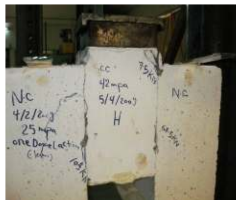
(d) Interface shear reinforcement
