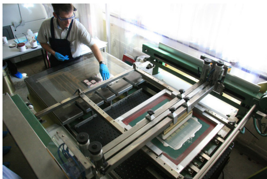
Ffigwr 2: Creu'r lampau drwy ddefnyddio peiriant printio sgriniau. Dangosir y dull o wneudlampau ar ITO. Ar bapur mae'r drefn yn wahanol, gyda haen ychwanegol o PEDOT:PSS ar ben y ffosfor.
