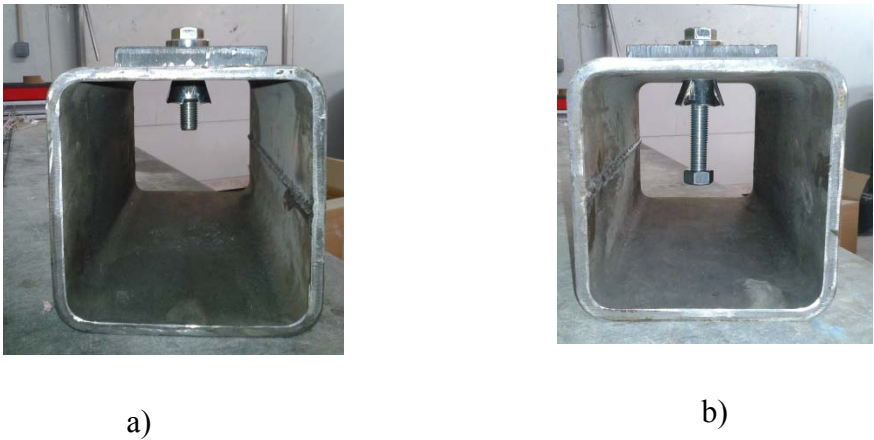
Fig. 3. Test specimens before pouring concrete: a) Hollo-bolt, b) Extended Hollo-bolt.
