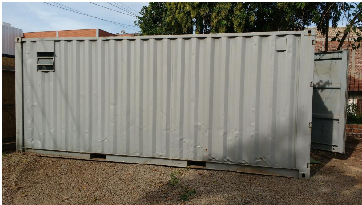
Figura 27 – Contêiner sem isolamento térmico usado nas medições in loco
