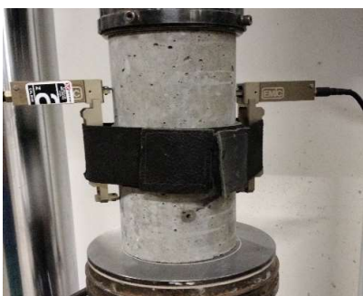
Figura 27 - Extensômetros fixados no corpo de prova.
