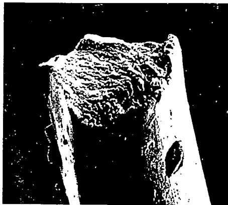
plate XLV. Tensile break - silk (x3000).
