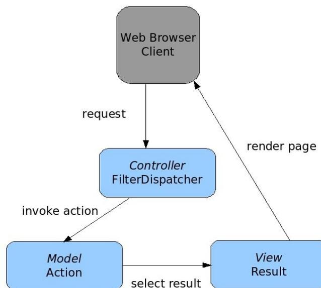
En el caso de *Struts*, se implementa una variante del patrón MVC conocida como *front controller MVC*, lo que significa que el controlador se encuentra en el inicio y es el primer componente que actúa en el procesamiento. Principalmente, el objetivo de un *controller* es el procesamiento de mapear una solicitud entrante hacia una *action* concreta, dado que, en una aplicación web, las solicitudes HTTP entrantes pueden considerarse como *commands* que el usuario dirige a la aplicación.
