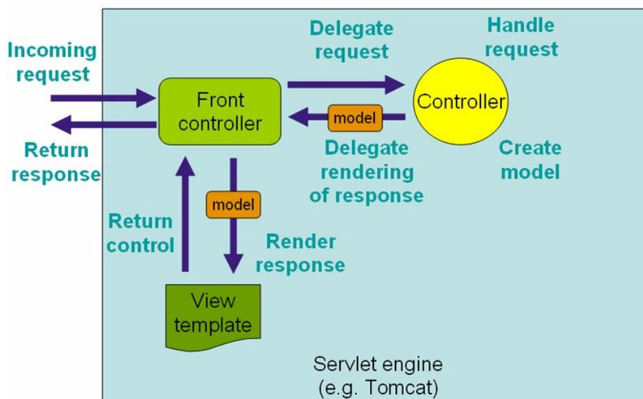
El componente *DispatcherServlet* es en realidad un *Servlet*, el cual se declara en el fichero *web.xml* de la aplicación, especificando un patrón de mapeo que indica que solicitudes deberán ser gestionadas por dicho controlador. Además de esto, cabe considerar que cada *DispatcherServlet* posee su propio *WebApplicationContext*, el cual hereda todos los *beans* definidos en el *WebApplicationContext* raíz. Principalmente, mediante la utilización de este último, tenemos la
