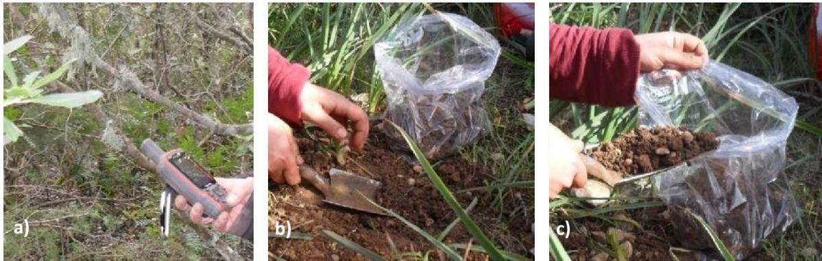
**Figura 5.2.1:** a) localizzazione punto di campionamento con GPS; b) prelievo campione di suolo; c) collocazione campione di suolo all'interno del sacchetto in plastica.
