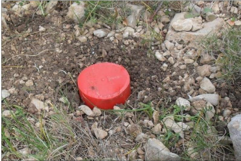
**Figura 5.2.2:** Carotaggio con cilindro, per la determinazione della densità apparente del suolo.
