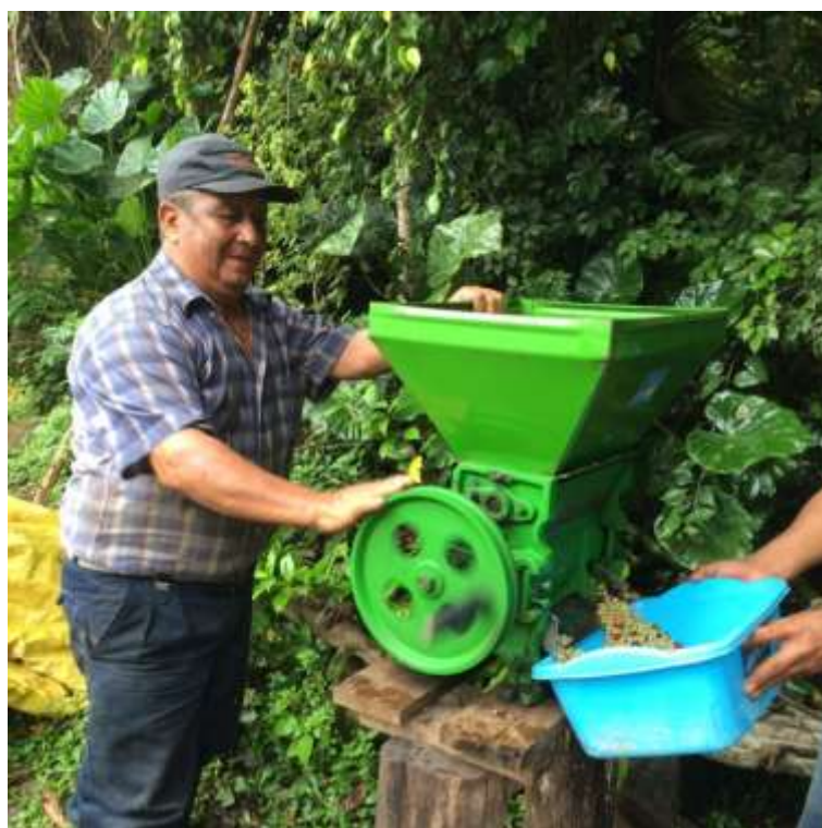
Fig. 5.3 Depolpatrice per il caffè (distretto di Churuja)
