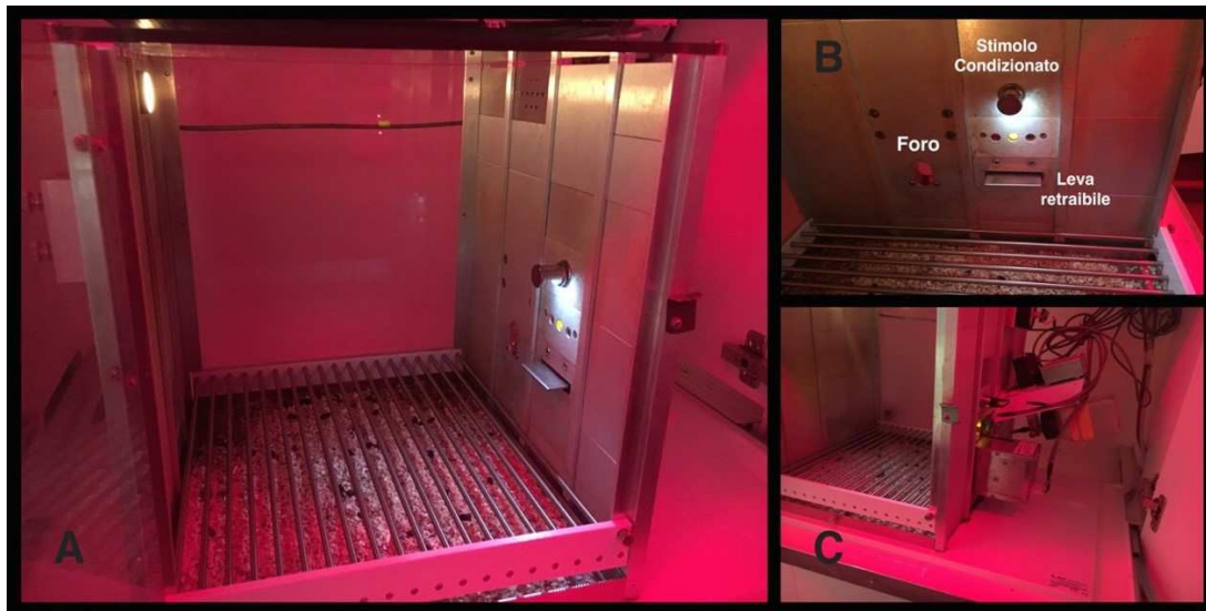
Figura 6. Gabbia per il comportamento operante.
