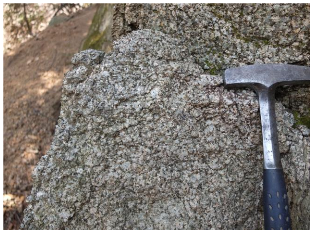
写真5 花崗岩 表層部は風化している。墓地裏の放棄された石切り場
