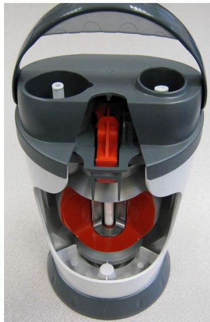
Vista interna de un generador de ^{99}\text{Mo}/^{99\text{m}}\text{Tc} . A la derecha se coloca el vial con solución fisiológica y a la izquierda se coloca el vial evacuado en el que se recupera el ^{99\text{m}}\text{TcO}_4\text{Na} .
