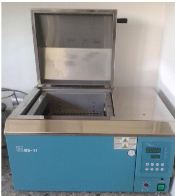
**Figura 4.1.** Shaker con agitación recíproca y baño térmico de agua JEIO Tech BS-11 utilizado para realizar las maceraciones.
