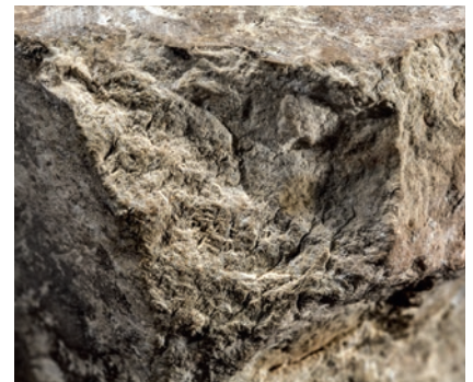
Abb. 22: Feinkörnige, homogene Ausprägung des kreidigen Kalkes. M. 1:1.
