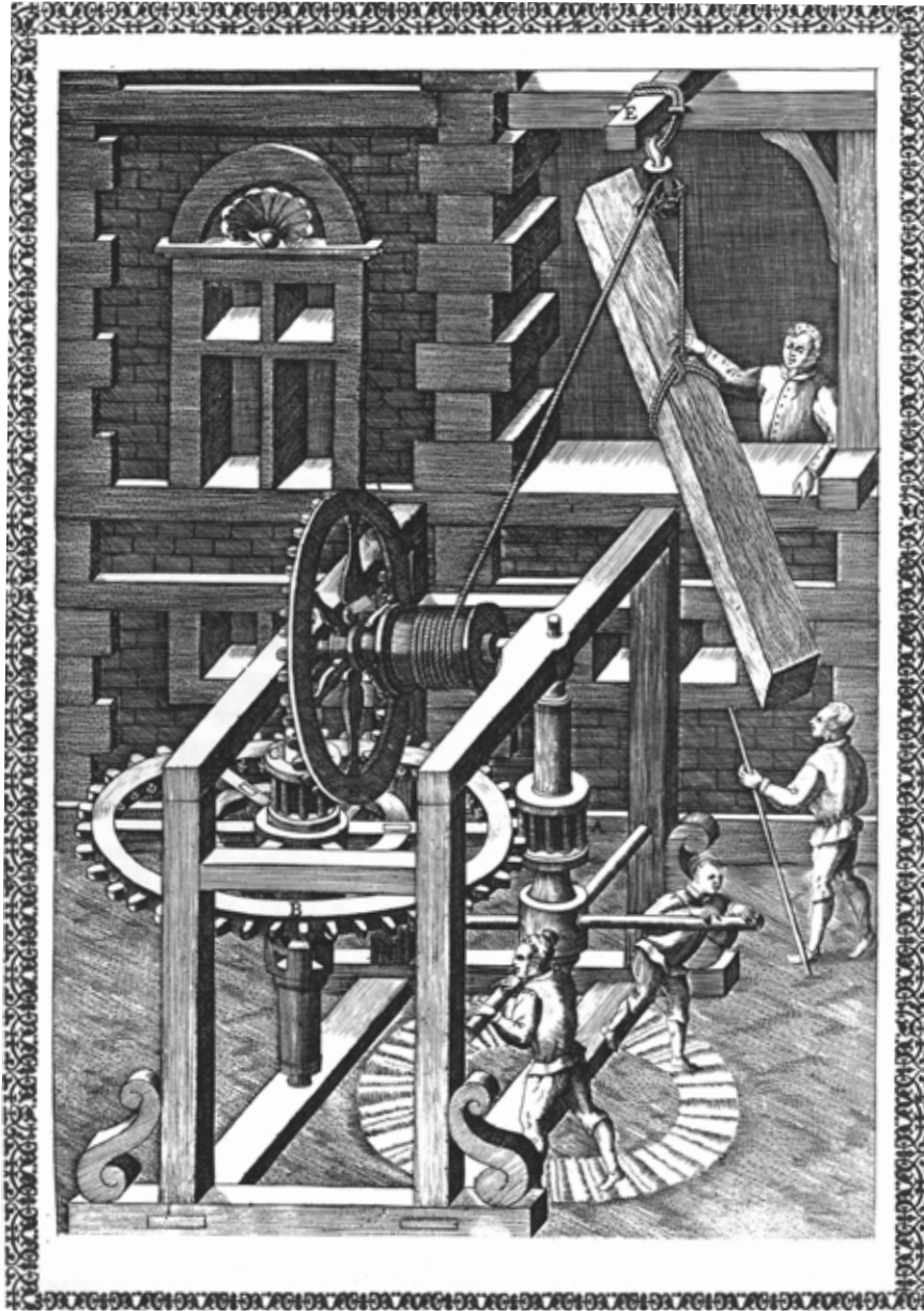
Hebegerät mit einem Getriebe, das eine Übersetzung in das Langsame ermöglicht. Damit ließen sich mit kleinen Kräften große Lasten
