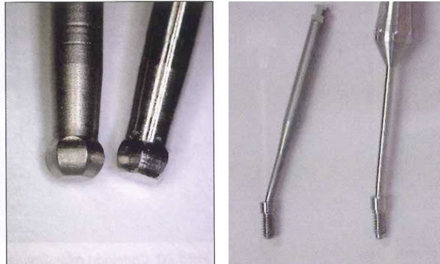
Fig. 23. Comparativa eina i angulació entre Talladium – Iclonné.
