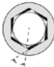
Fig. 4. Angle de contacte de l'enllaç Allen.
