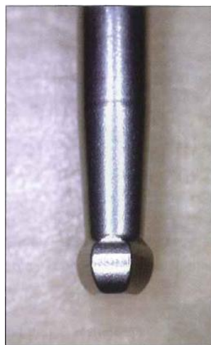
Fig. 17. Detall bola hexagonal eina Talladium.
