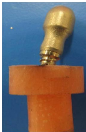
Fig. 122. Mostra després de l'assaig a resistència estàtica
