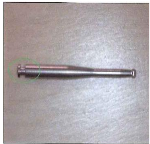
Fig. 18. Eina Talladium. Detall connexió contra-angle.
