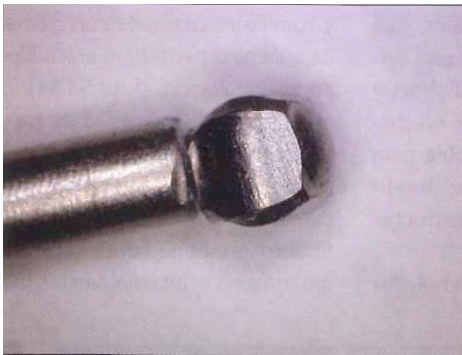
Fig. 48. Trencament del cap de l'eina.
