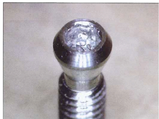
Fig. 30. Coronament del cargol a 16,3 N·cm.
