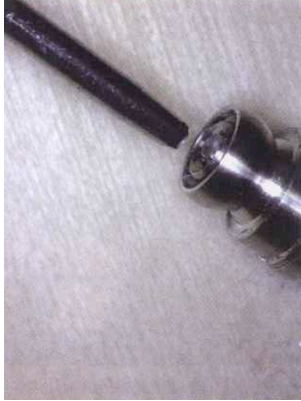
Fig. 33. Rotura eina a 20,1 N·cm.
