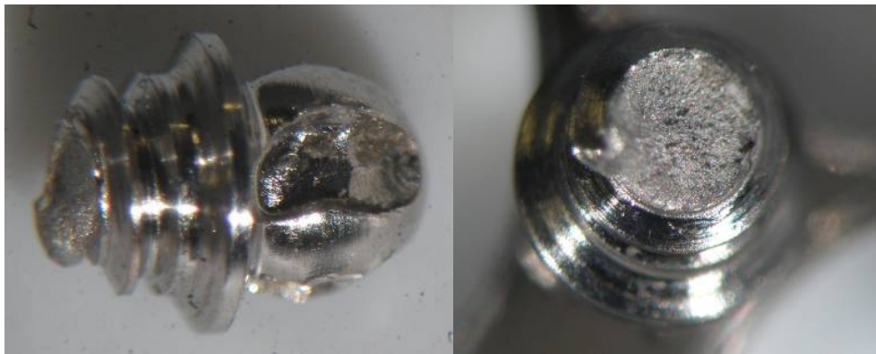
Fig. 110. Detall de la trencada per la rosca (esq.) i imatge de la superfície de fractura (dta.).
