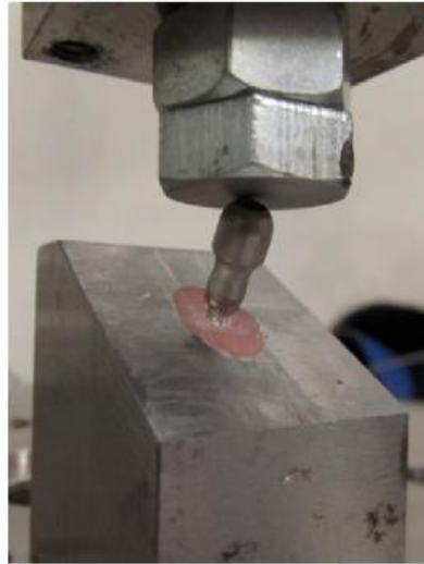
Fig. 100. Muntatge del conjunt de connexió externa hexagonal: Assaig de la mostra.
