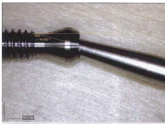
Fig. 26. Muntatge cargol-eina màx. angulació, 14,50^\circ .
