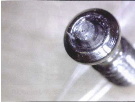
Fig. 43. Detall trencament eina.
