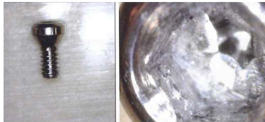
Fig. 38. Rebaves al cap del cargol Mètrica 1,4 mm.
