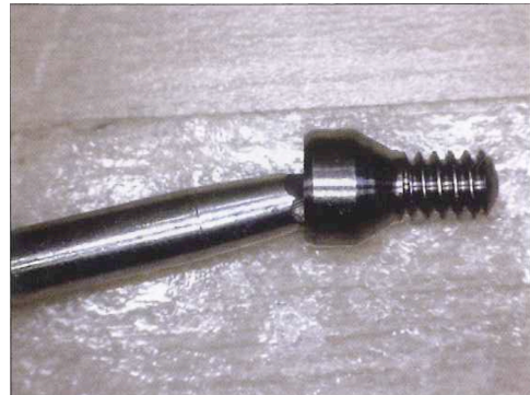
Fig. 32. Muntatge cargol-eina. Angulació màx. 14°.
