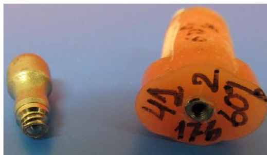
Fig. 123. Mostres després de l'assaig a resistència a fatiga.
