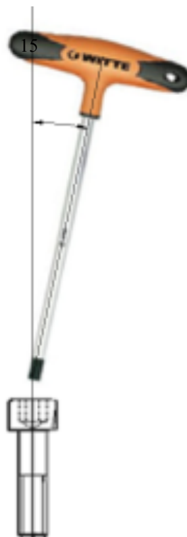
Fig. 61. Angle d'inclinació de l'enllaç bola Allen.
