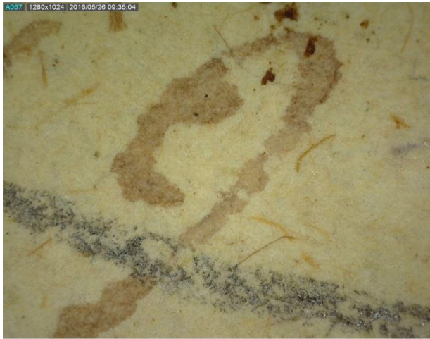
Inscripció amb tinta metal·loàcida tatxada amb grafit (50x) Detall de la impressió tipogràfica (50x)
