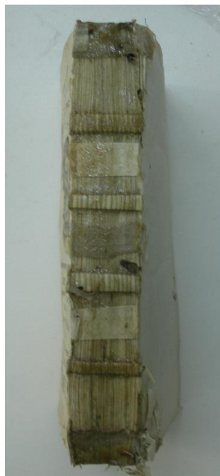
Detall del cosit amb les betes d'ancoratge
