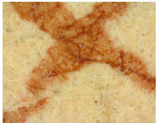
Detall de les fibres amb tinta(200x)
