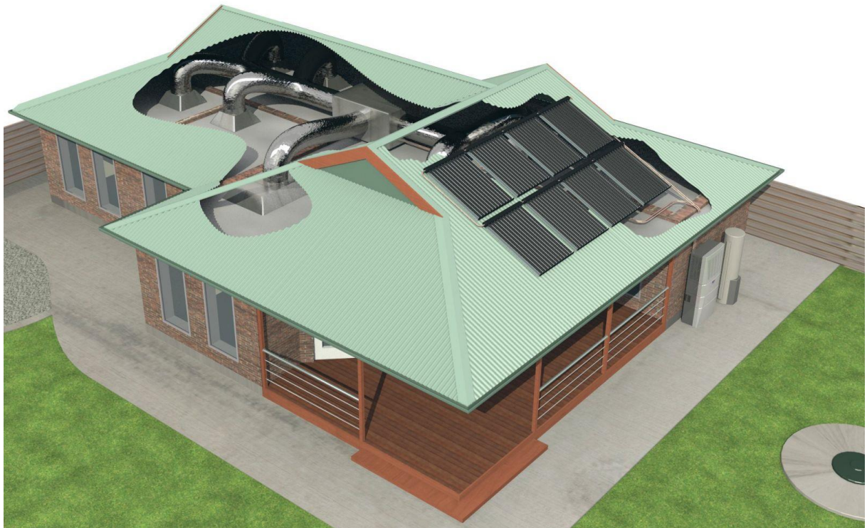
Slika 10 Zamišljeno Mikro-ORC postrojenje [16]
