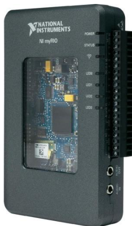
Slika 11. Upravljački uređaj myRIO-1900
