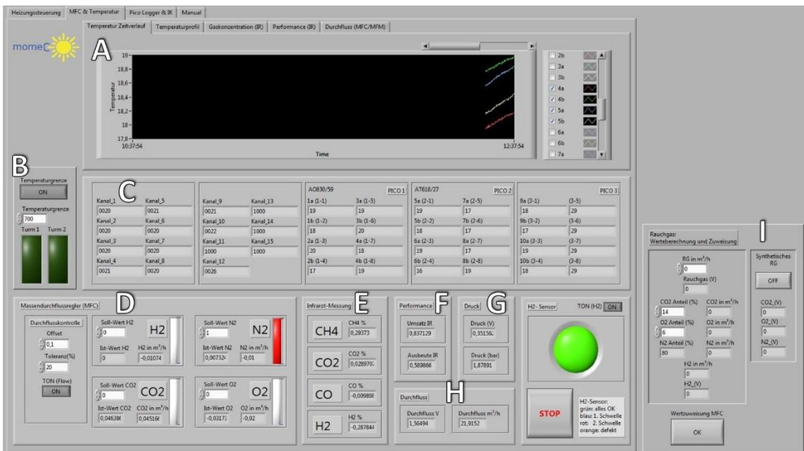
Abbildung 67 LabView-Programm der Technikumsanlage, Tab 2: MFC-Steuerung und Messwert-erfassung
