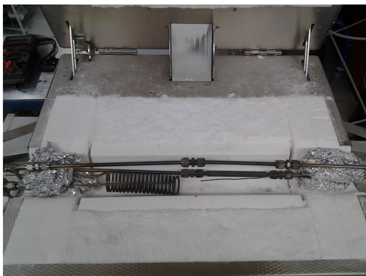
Abbildung 65 Reaktor im Ofen der Laboranlage. Zusätzlich ist der Bypass und die Spirale zur Gasaufheizung zu erkennen.
