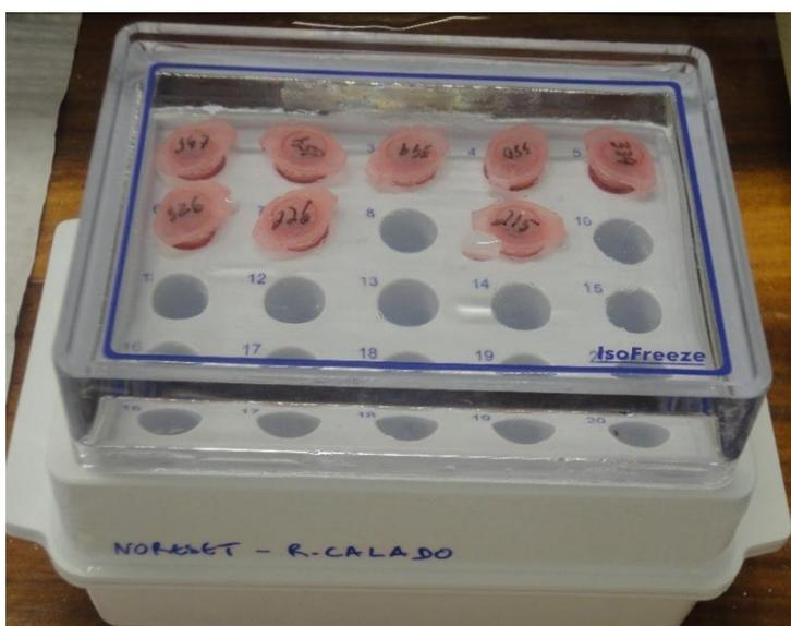
**Figura 23.** Termoacumulador para manter as amostras refrigerados até dissolução para posterior análise no GC-MS.
