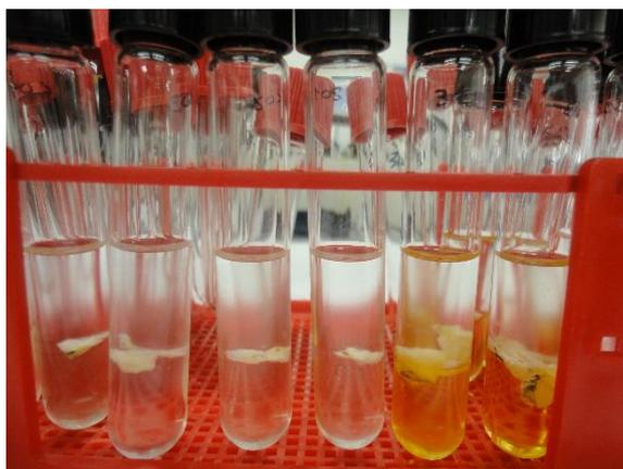
**Figura 18.** Tubos de extração lipídica, após centrifugação. Fase orgânica na parte inferior, fase aquosa na parte superior.
