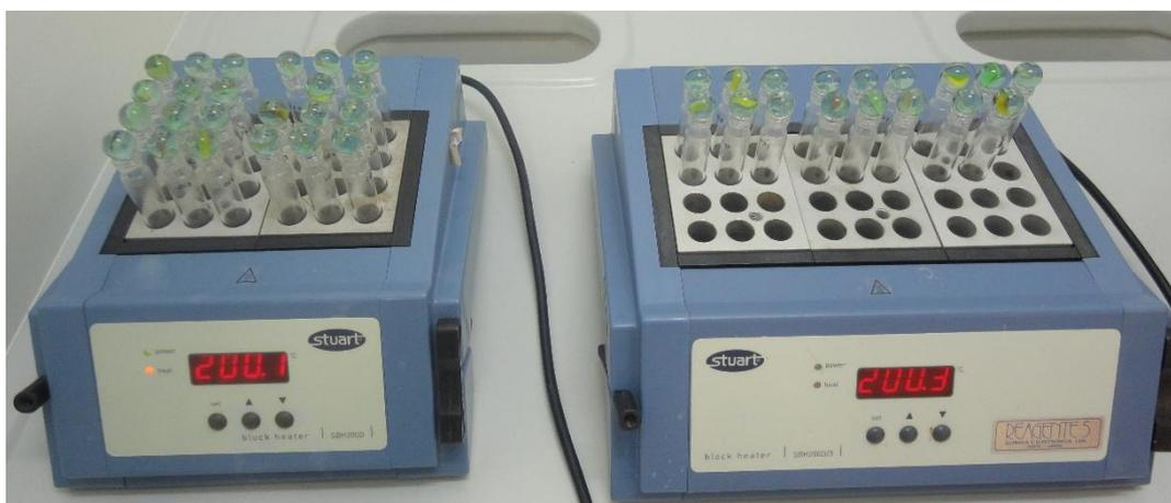
**Figura 20.** Incubação em calor das amostras a 200 °C
