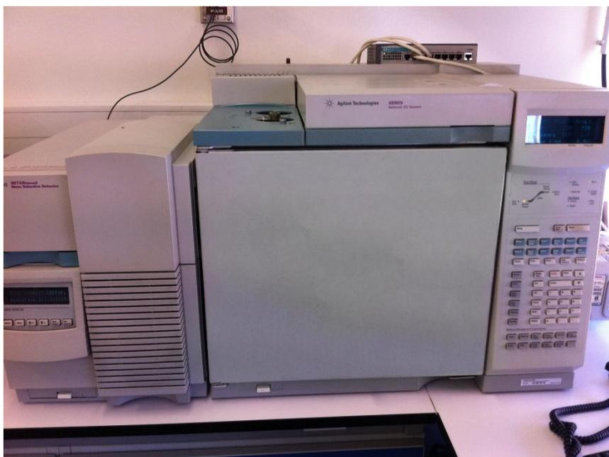
**Figura 24.** Cromatografia gasosa associada a espectrometria de massa (GC-MS)
