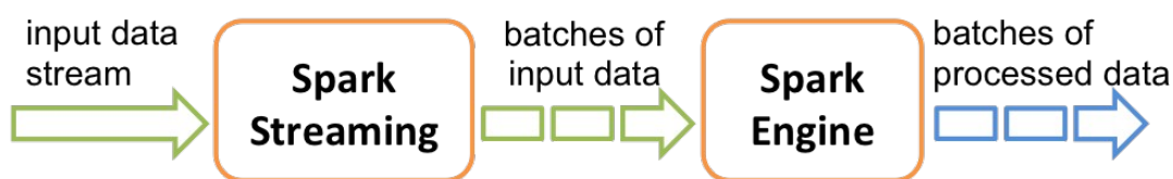
Figura 14: Fluxo de dados spark streaming
