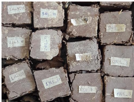
Figura 33 Cubos naranjas ensayados
