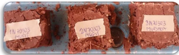
Figura 35 Cubos naranjas ensayados
