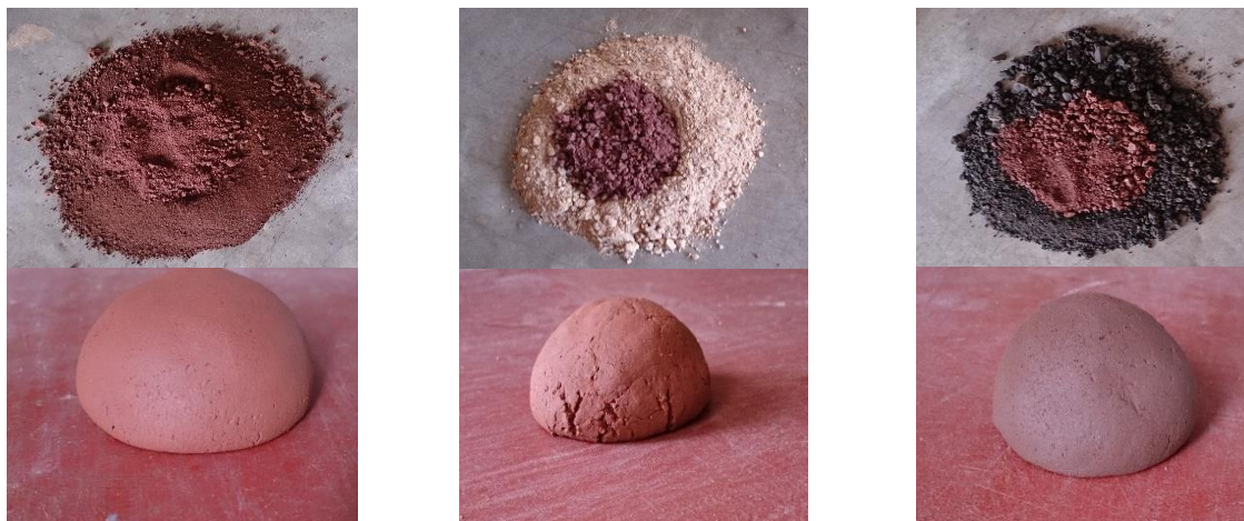
Figura 13 Prueba de bolita suelos combinados
