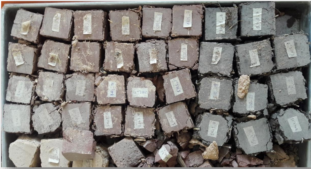
Figura 32 Cubos puros ensayados
