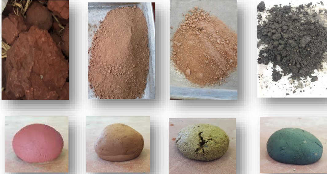
Figura 12 Prueba de bolita suelos puros
