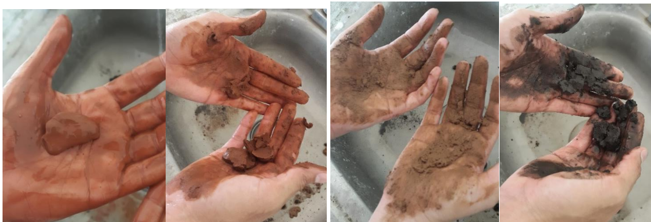
Figura 14 Prueba de lavado
