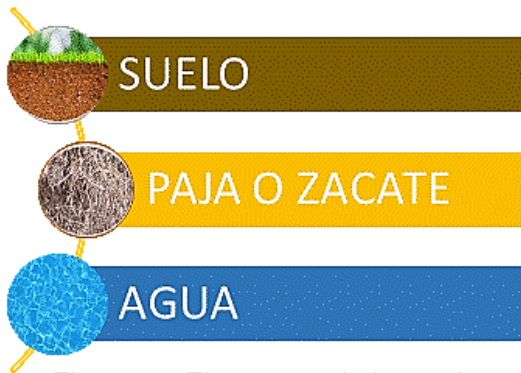
Figura 29 Elementos de la mezcla
