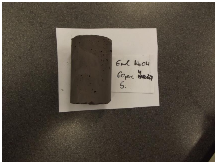
3. ábra. őrölt visontai pernyéből készített próbatest (geopolymer specimen)
