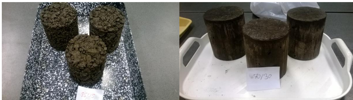
9. ábra. Geopolimer beton termékek 85/15 (bal oldal) és 70/30-as (jobb oldal) adalékanyag/kötőanyag arányánál ( L/S=1 a kötőanyagban) (Geopolymer cast specimens with 85/15 – left – and 70/30 – right – additive/binder ratio, L/S=1 in the binder)
