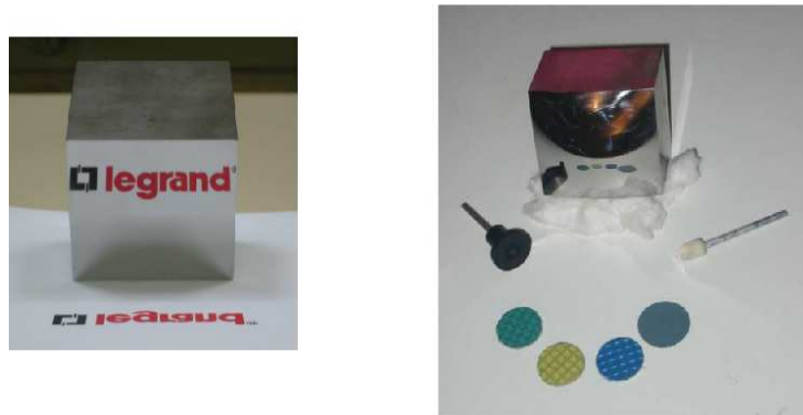
FIGURE 1.7 – Pièces polies sur centre d'usinage 5 axes et matériel de polissage
