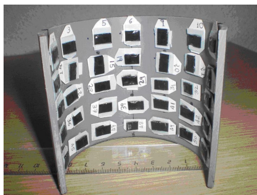
Figura 2.10: Malla de TLDs, para medir la distribución angular de la dosis
