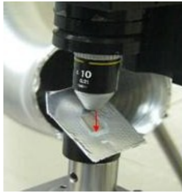
Figura 3.1: Blanco de aluminio perforado por pulsos láser incidiendo verticalmente. La flecha roja indica la dirección de incidencia del haz
