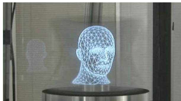
Fig. 1. Imagen holográfica de visualización 3D. Se pueden ver diferentes partes de la imagen dependiendo de la posición en que se mire el holograma. El usuario puede mirar por detrás del objeto al igual que lo hiciera como si este se encontrase ahí. Este holograma despliega una imagen tridimensional idéntica a un objeto sólido derivada de un modelo, escultura o de una imagen generada por computadora.
