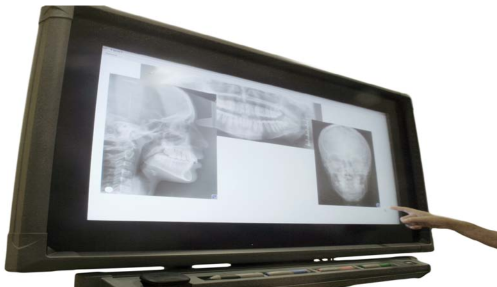
Figura 9.- Pizarra digital interactiva multipunto, modelo SmartBoard, que disponemos en nuestras instalaciones de Abadía Group. No requiere conexión a cañón de proyección. Funciona directamente conectado al ordenador. Dispone de lapiceros de cuatro colores y borrador. Su manejo se puede desarrollar directamente con las manos, ofreciendo un gran dinamismo. En la imagen se visualiza unos de los proyectos desarrollados por nuestro grupo: negatoscopio digital interactivo (NID).
