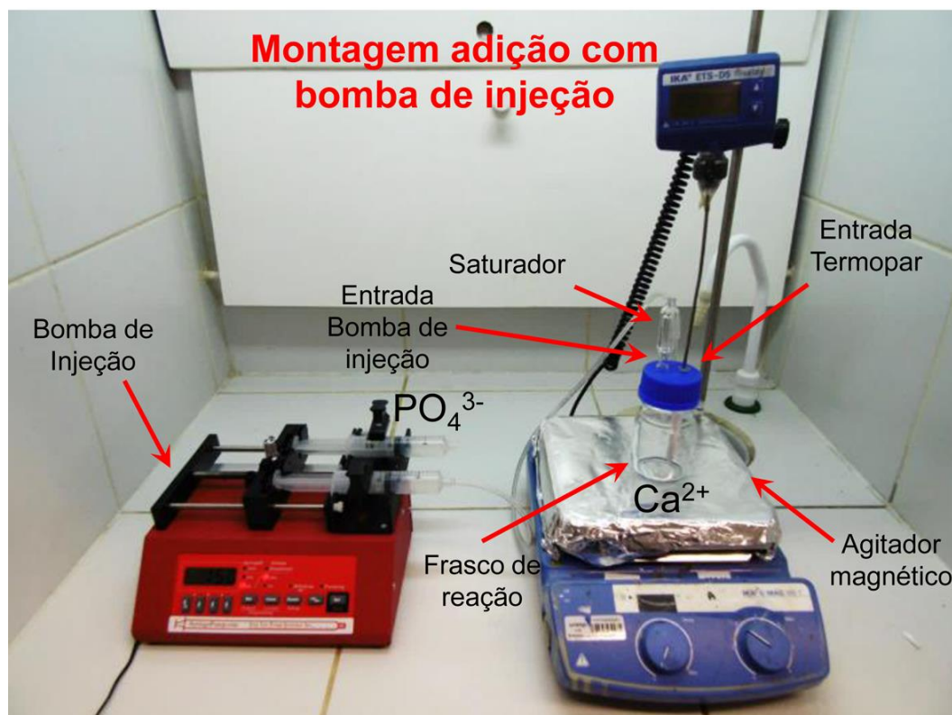
FIGURA 3.1 – Esquema de montagem dos equipamentos utilizados para a síntese com bomba de injeção.
