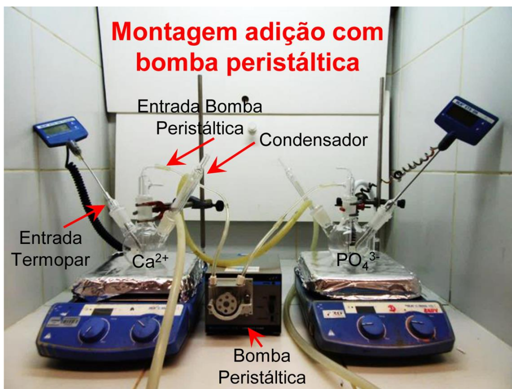
FIGURA 3.2 – Esquema de montagem dos equipamentos utilizados para a síntese com bomba peristáltica.
