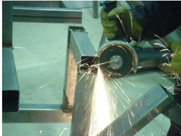
Figura 34 - Tubo de aço a ser cortado com rebarbadora.
