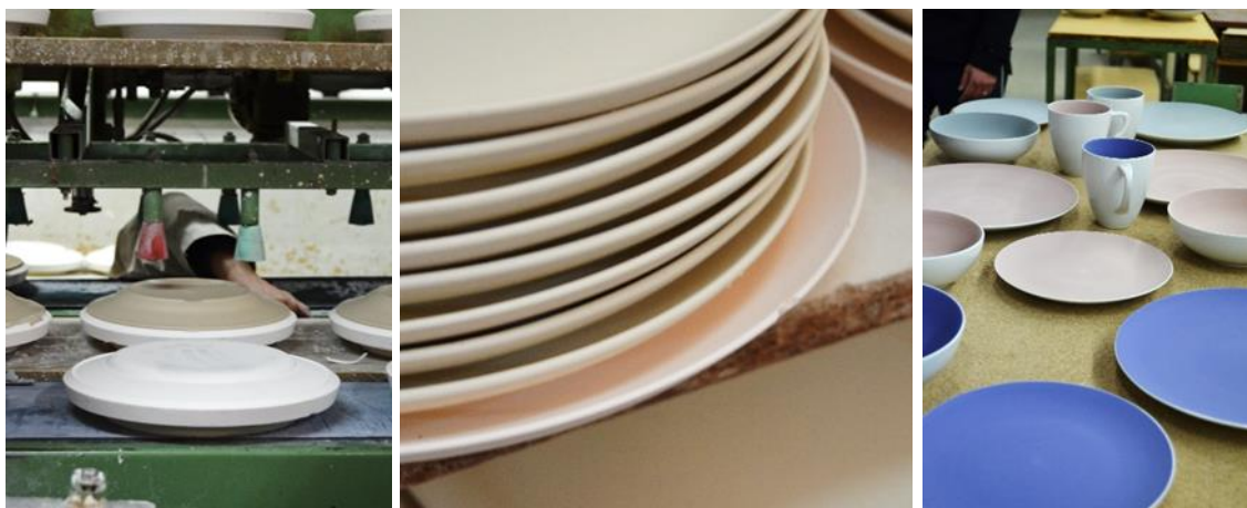
Figura 30 - Conformação de um prato e resultado do produto final.
