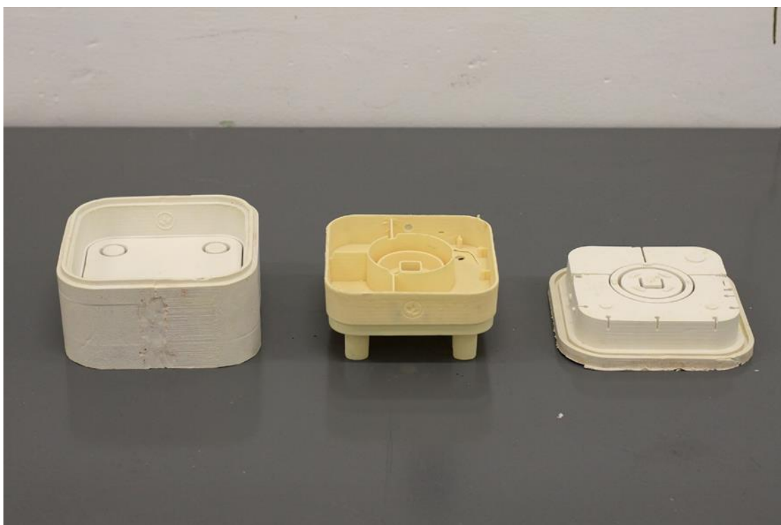
Figura 73 - Kits de Hidroponia. Impressão em Powder bed Inkjet 3D Printing, produção de moldes em silicone para replicação do objecto em resina de poliuretano.
