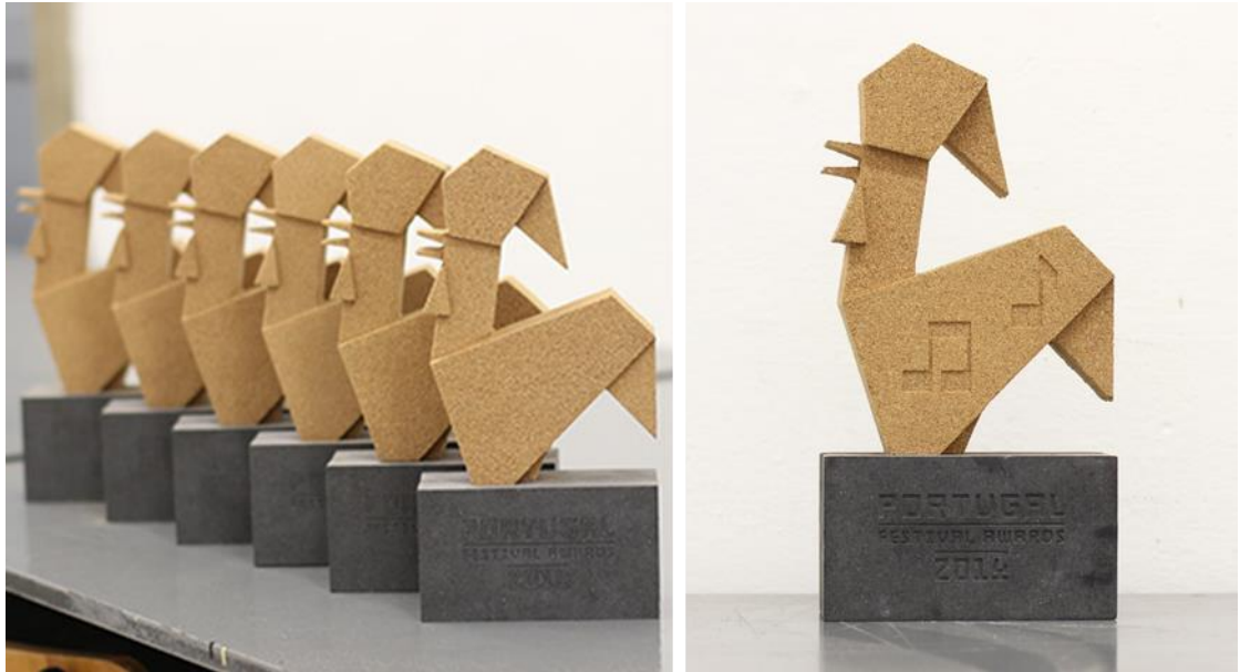
Figura 74 - Troféu com a Maquinação CNC de cortiça e valchromat e respectiva colagem e acabamento das diferentes partes
