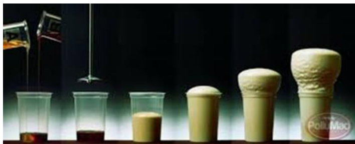
Figura 26 - Processo de formação de poliuretano expandido.
