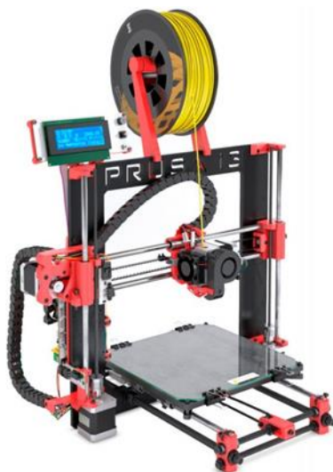
Figura 57 - Pursa I3 Máquina de modelação por extrusão de plástico;
