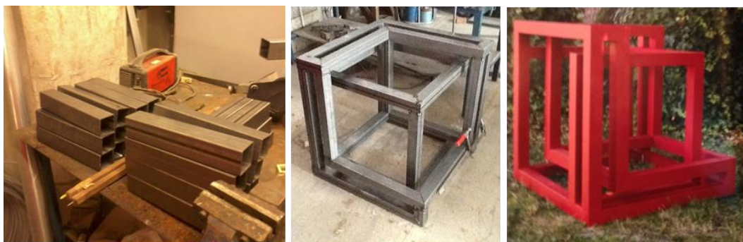
Figura 63 - Processo de construção da peça. 80x80x80 cm.
