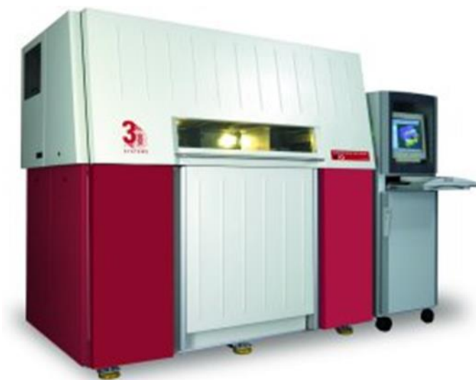
Figura 56 - Máquina de Sinterização Selectiva por Lazer da DTM.
