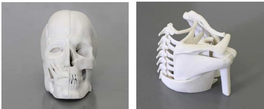
Figura 70 - Modelos anatómicos. Impressão em FDM (PLA) e em Powder Bed Inkjet 3D Printing com acabamento em cianoacrilato.
