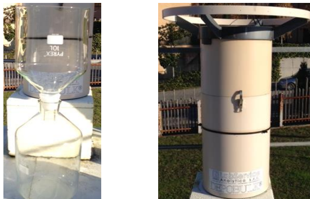
Figura 24. Muestreador de vidrio Pyrex silanizado DEPOBULK ® , con su soporte.
