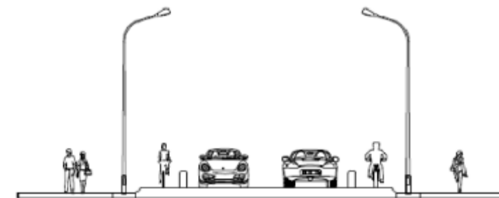
Fig. 2. Sección de Carril-Bici protegido o segregado
