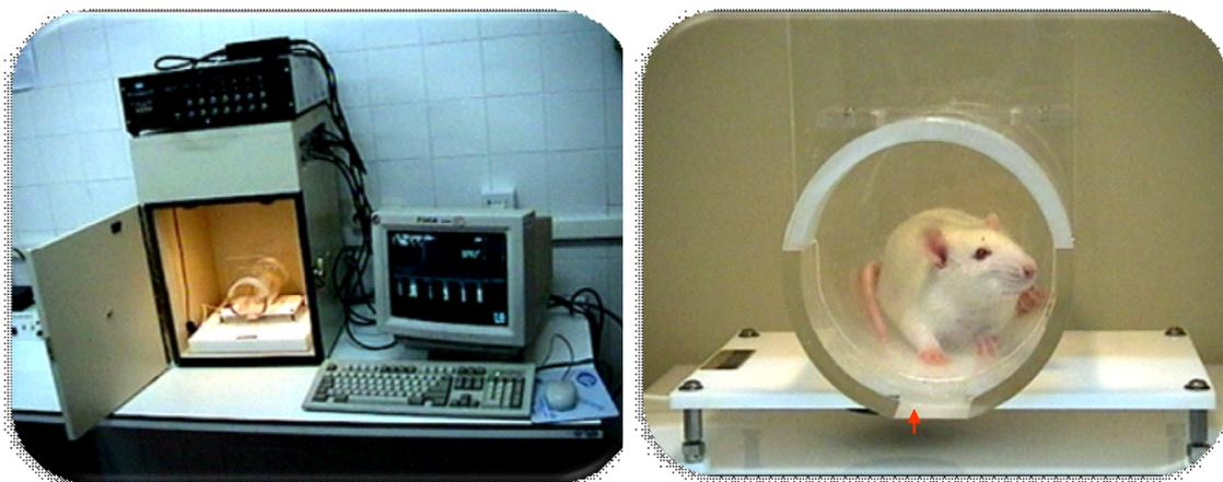
**Figura 6:** Sistema SR-LAB donde se han llevado a cabo las mediciones del RAS y de la IEP. En la imagen de la derecha se puede observar en detalle, el cilindro en donde se coloca el animal que lleva una plataforma con un acelerómetro (la flecha) susceptible de detectar todos los movimientos del animal.
