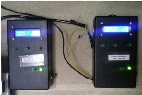
**Figura 23 – Equipamento datalogger para registro de acionamento da bomba.**
