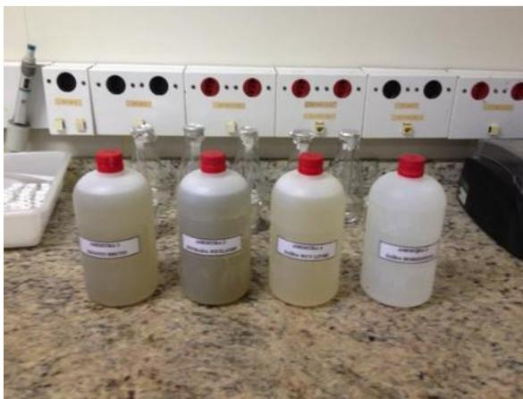
**Figura 25 - Amostras do esgoto afluyente e efluente ao sistema híbrido. Da esquerda para a direita: Esgoto Bruto, Pós-TS, Pós-WCFV, Pós-WCH.**
