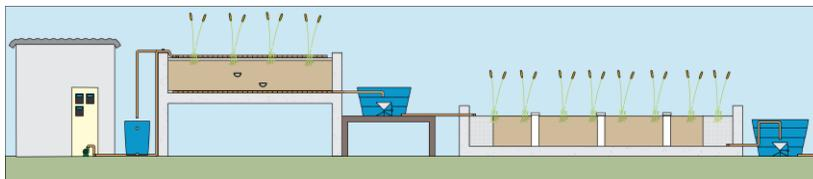
**Figura 14 - Corte da linha de tratamento do arranjo híbrido e posicionamento dos amostradores em pontos intermediários.**
