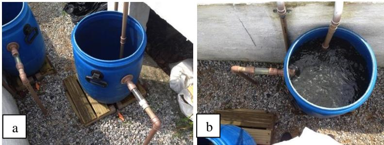
**Figura 22 - Aparato para medição de vazão aplicada.**
