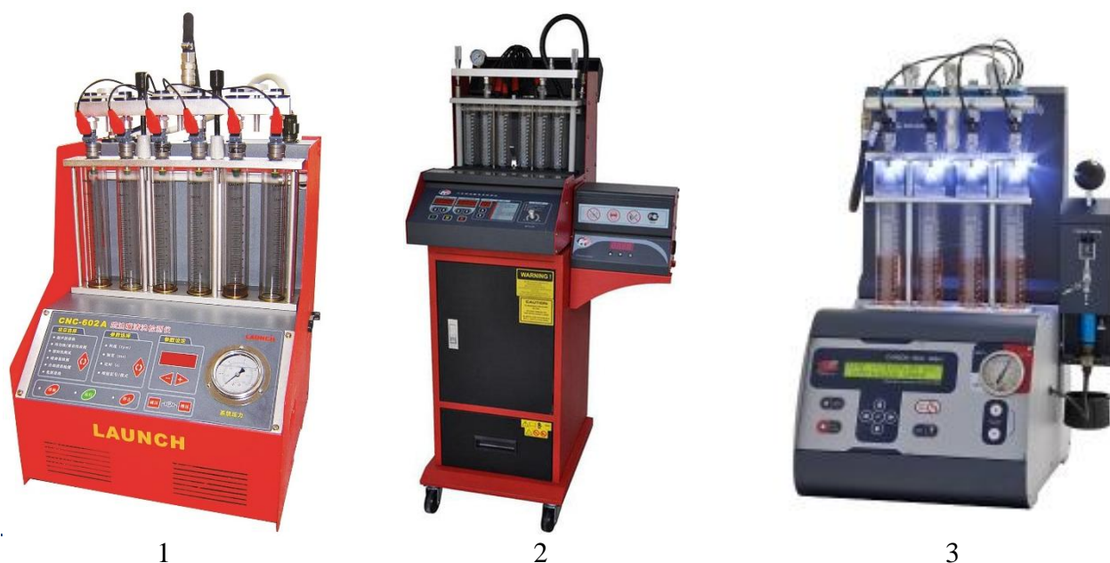
1 – Установка для диагностики и чистки форсунок CNC-602; 2 – Стенд для диагностики и чистки форсунок ISSA DH60A+ ; 3 –Оборудование для диагностики инжектора GS4 CARBON TECH. Рисунок 3.1 – Установки для диагностики и чистки форсунок
