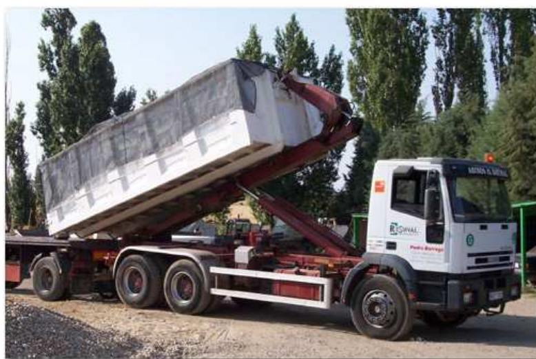
Fig 11. Contenedor de 24 m 3 y camión adecuado para el transporte.
