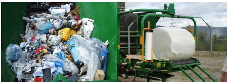
Fig 8. Imágenes del proceso de compactación de la MP2000.
