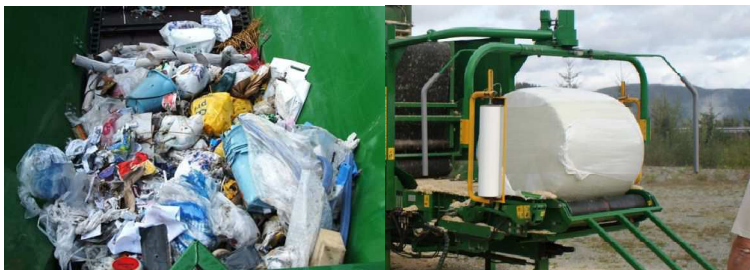
Fig 18. Imágenes del proceso de compactación de la MP2000
