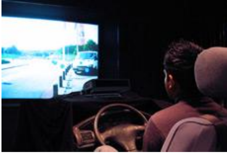
Imatge d'un simulador de conducció utilitzant Tobii X120 Eye Tracker de conductors.
