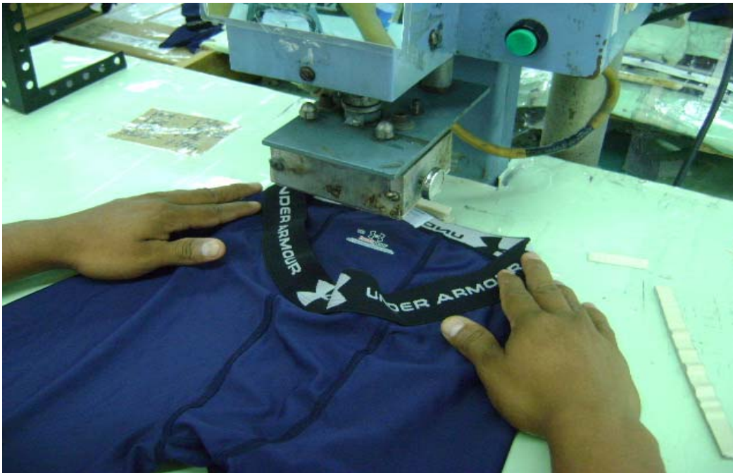
Imagen 55. Operario pegando el iner (logotipo donde se describe la marca, talla y la temporada del bóxer)
