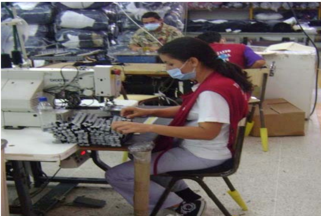
Imagen 56. Operaria remachando Elástico, en su respectiva maquina.
