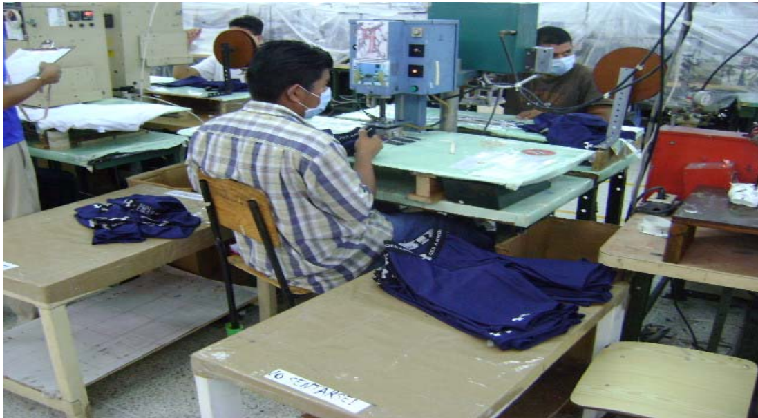
Imagen 19. Operarios pegando logo, en el bóxer ya terminado.
