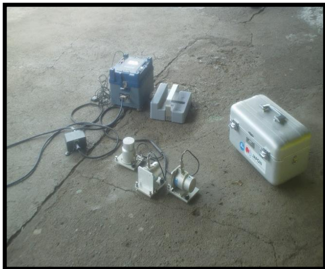
Fig. 4.2 Acelerómetro McSEIS-MT NEO y sismómetros empleados en el estudio.
