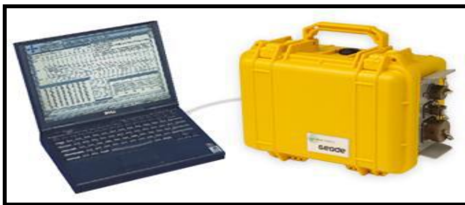
Fig. 4.9 Sismógrafo marca GEODE utilizado para mediciones de MASW (Propiedad del CIGEO de la UNAN-Managua).
