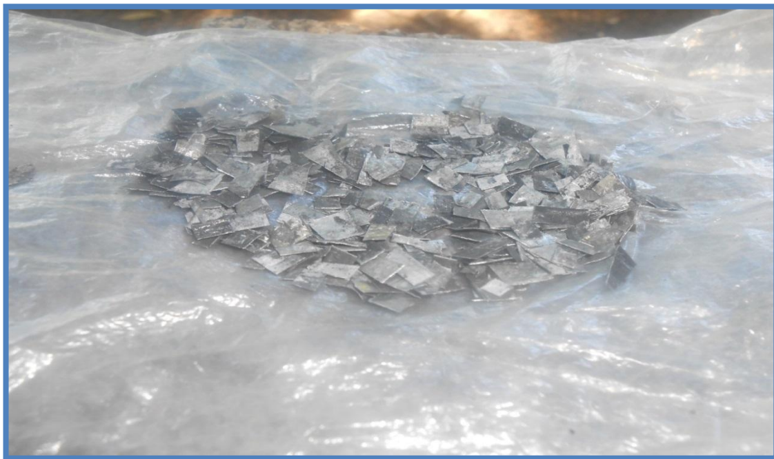
3. Láminas de zinc ya cortadas aumentando así su área superficial
