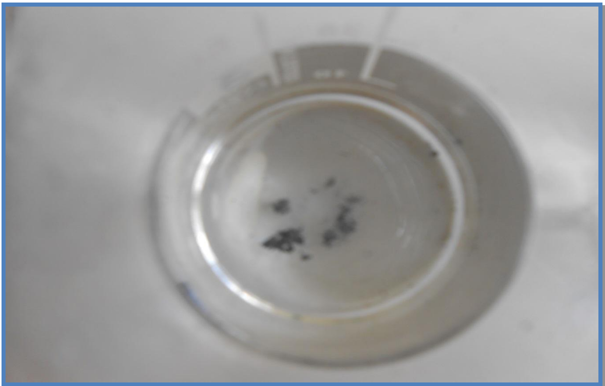
8. Apresiación de la solución de Cloruro de zinc donde se ve por completo casi la dilución de las láminas de zinc.
