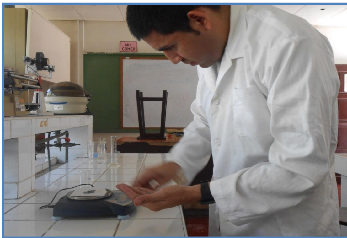
4. Peso de la masa de láminas en la balanza semianalitica 5 gramos de zinc previamente tratado
