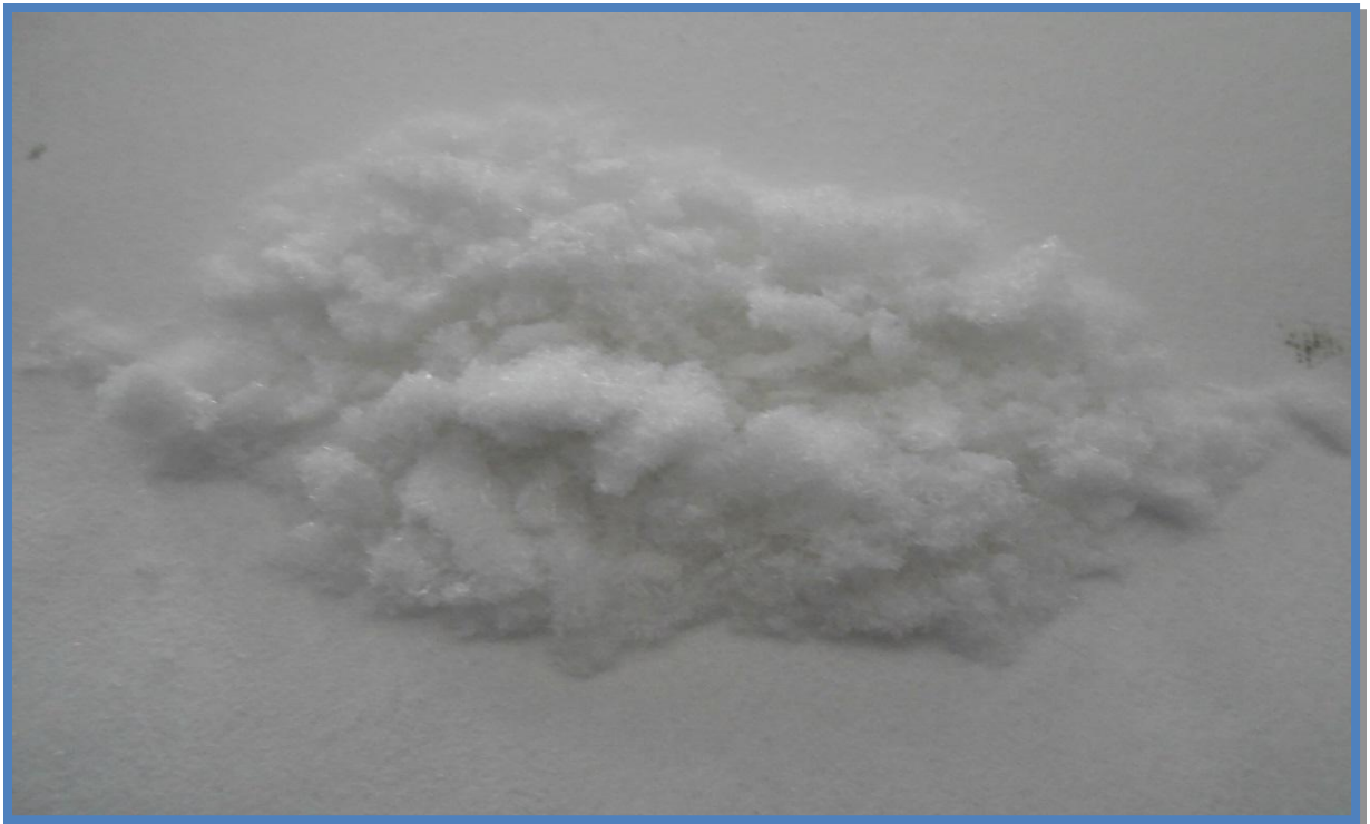
14. Producto final obtenido cristales de \text{ZnSO}_4 para su uso previo
